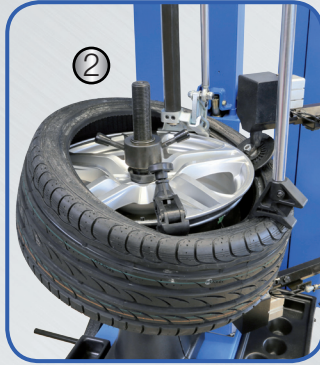
(1) Dinamik Lastik Sökme Ekipmanı (2) Otomatik, Havalı Jant Tırnağı (3) Kullanıcı Dostu Kontrol Ünitesi (4) Otomatik Montaj Kafası (5) Kolay Lastik Yerleştirme
