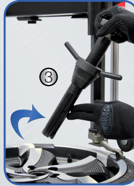
(1) Profesyonel Kullanım İçin Destek Kolu (2) Emniyetli ve Kullanımı Rahat Lastik Şişirici (3) Otomatik Merkezleme Yapan Çene Sistemi (4) Lastik Asansörü
