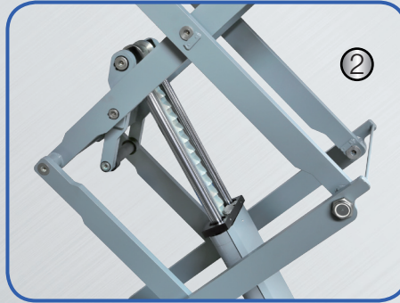
(1) Otomatik Kilitleme ve Kilit Açma Sistemi (2) Külbütör Makas Sistemi (3) Ultra Alçak Yapı
