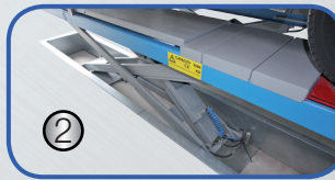
(1) 4 Adet Aydınlatma Elemanı (2) Zemine Gömme (3) Uzun Şasili Ticari Araçlara Uygun, Uzun Platform Boyu
